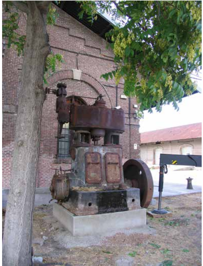
4. Relleno de la base-soporte para motor Winterthur depositado en exterior. El colmatado evita anidar a animales superiores. Pieza colección MUNCYT. Fotografías: Joaquina Leal.
