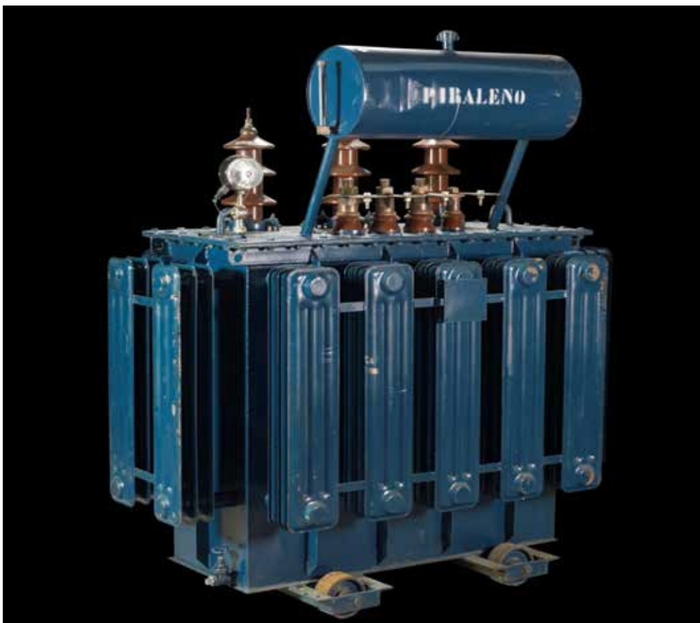
3. Transformador de alta tensión de 15000 V a 380 V 500 KVA relleno de Piraleno (bifenilo policlorado) utilizado como fluido dieléctrico. Pieza colección MUNCYT. Fotografía: José Latova.
