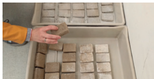
Imagen 1. Curado de las probetas de mortero de cemento Portland I
