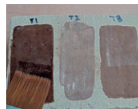
Imagen 6. Aplicación de hidrofugantes sobre soportes pintados (H)
