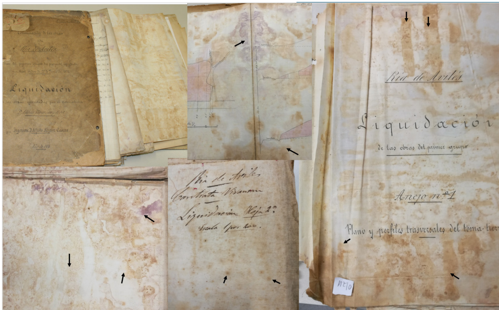
Figura 2. Diferente tipología de manchas presentes en los materiales del conjunto documental.
