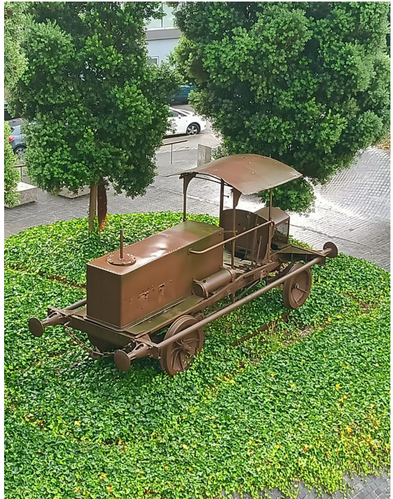
5. Alteraciones por causas antrópicas y biológicas de piezas expuestas en el exterior. Pieza colección MUNCYT. Fotografías: Joaquina Leal.
