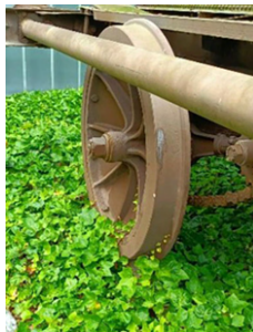
5. Alteraciones por causas antrópicas y biológicas de piezas expuestas en el exterior. Pieza colección MUNCYT. Fotografías: Joaquina Leal.
